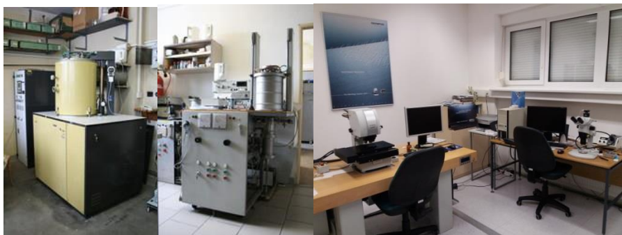
Obr. 6.3: Modernizovaná vakuová vertikální pec válcového tvaru Tesla PZ 810 (vlevo), malá laboratorní vakuová pec vlastní konstrukce (uprostřed) a optické mikroskopy Olympus LEXT OLS3100 (vpravo).
