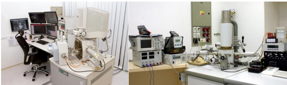
Obr. 6.1: Nový environmentální rastrovací elektronový mikroskop QUANTA 650 FEG vybavený mikromanipulátory a dalšími unikátními systémy (vlevo) a experimentální rastrovací elektronový mikroskop AQUASEM II, přestavěný týmem EEM na ÚPT AVČR v Brně (vpravo).
