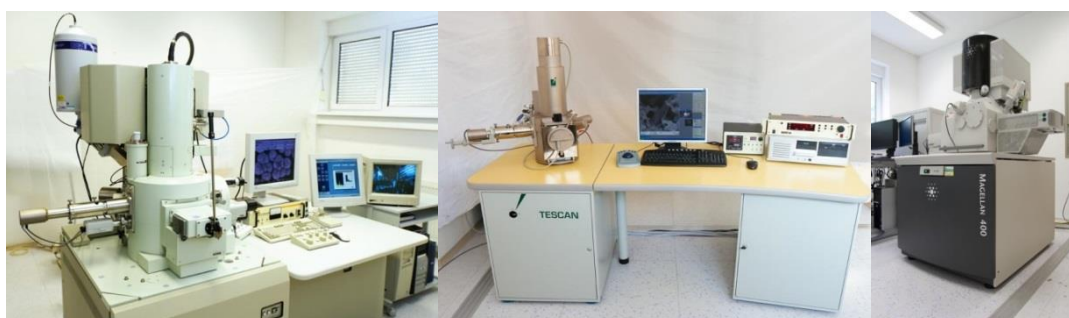
Obr. 6.2: Vysokorozlišovací rastrovací elektronový mikroskop Jeol JSM-6700 (vlevo), rutinní rastrovací elektronový mikroskop Vega od firmy Tescan s termoemísí katodou (uprostřed) a vysokorozlišovací rastrovací elektronový mikroskop MAGELLAN 400 od firmy FEI v ÚPT AVČR v Brně.
